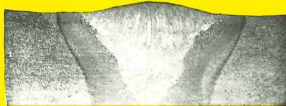
Bild 3 Vergrösserter Schnitt quer durch eine höchstfeste Schweissverbindung an dünnerem Blech. Geschweisst wurde mit Oerlikon-Fülldraht Fluxofil 45, 1,4 mm Durchmesser.
