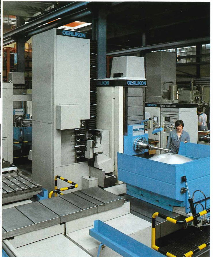
Oerlikon Horizontal-Bohr- und Fräswerk mit Antrieb und Positionierung von Spindeln, Vorschüben, Rotationstischen und Werkzeugmagazinen.
