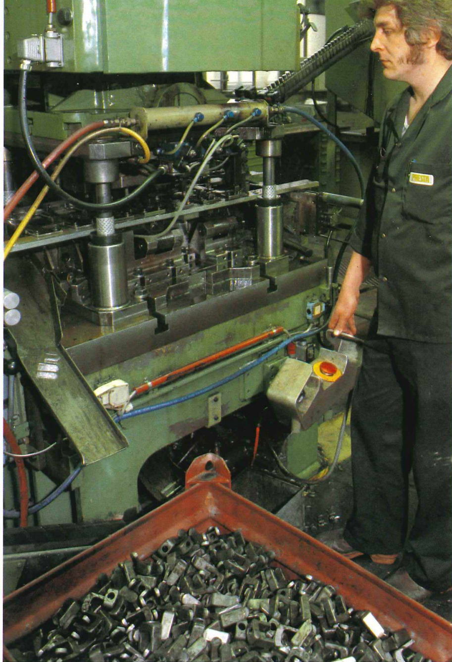
Das Beschneiden und Lochen von Gelenkgabeln geschieht auf einer 150-Tonnen-Mehrstufenbeschneidepresse.
