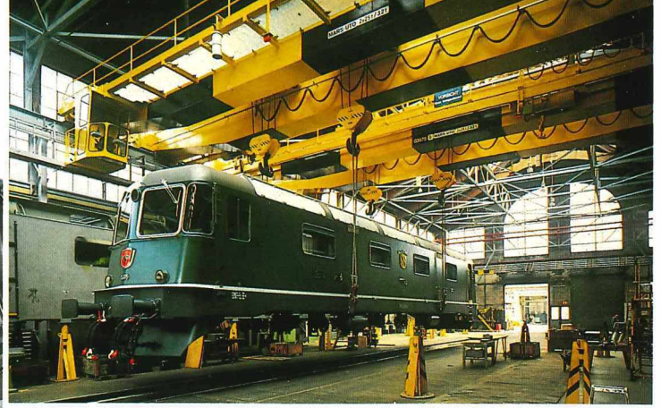
Montagekran mit vier synchron laufenden Gleichstrom-Antrieben mit je 25 Tonnen Hubkraft.
