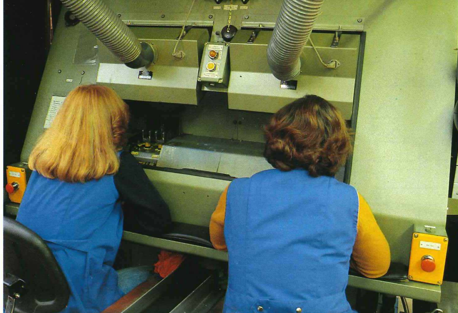
Auf einem 6-Stationen-Rundtakt-Zerspauungsautomat werden die Augenbohrungen der Gelenkgabeln bearbeitet.
