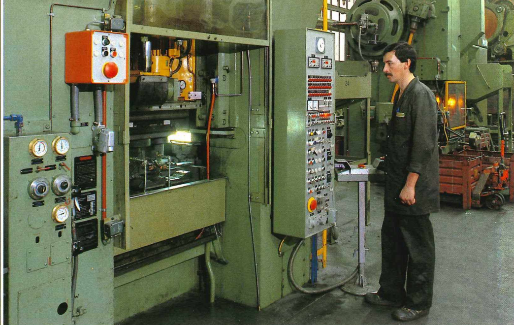
Die Gelenkgabeln werden in der Mehrstufenkaltfließpresse mit 630 Tonnen Druck aus einem Stück massgenau geformt.
