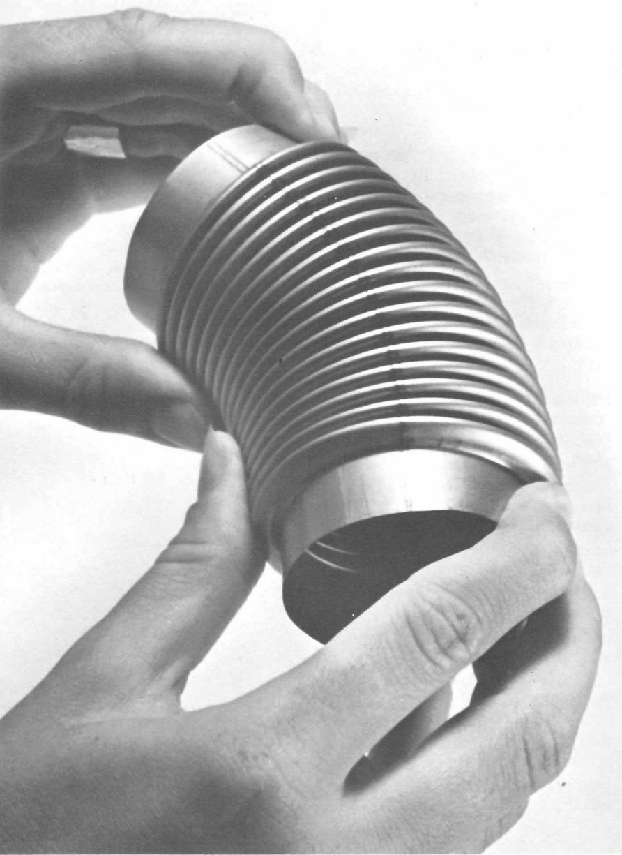
In der Längsrichtung geschweisster Metallbalg aus rostfreiem Stahl. Auswenddurchmesser 60 mm, Wandstärke 0,12 mm
