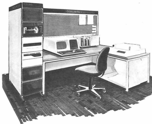
Am Autoprogrammer-80 werden die NC-Teilprogramme im Dialog mit einem Kleinrechner erstellt
