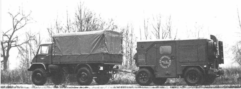
Skyguard – das kompakte, robuste und miniaturisierte Feuerleitsystem ist sehr mobil und schnell einsatzbereit. Für den Transport genügt ein Klein-LKW. Seine Abmessungen sind so klein gehalten, dass Bahn- und Lufttransportfähigkeiten gewährleistet sind
