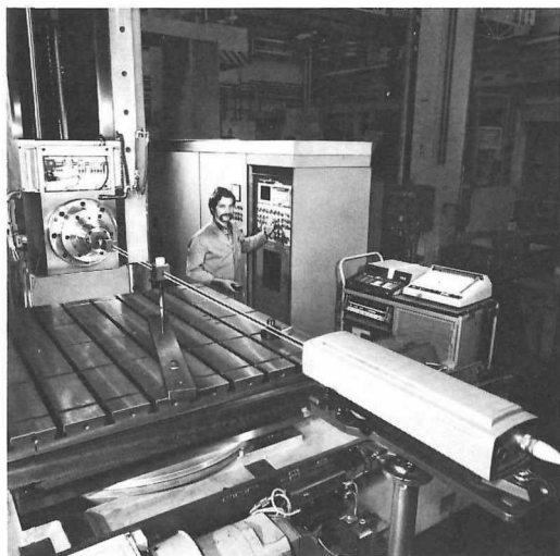
Die Positionier-Einfahrtgenauigkeit wird mittels Laser-Interferometers ausgemessen und über den angeschlossenen Plotter grafisch dokumentiert
