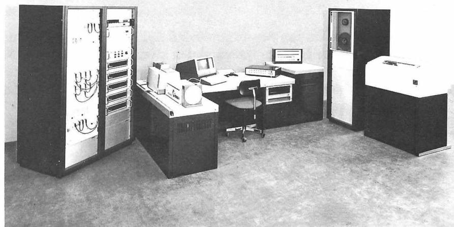
*Halbautomatisches Filmablesergerät, Modell AFC, für 35-mm-Film.*
