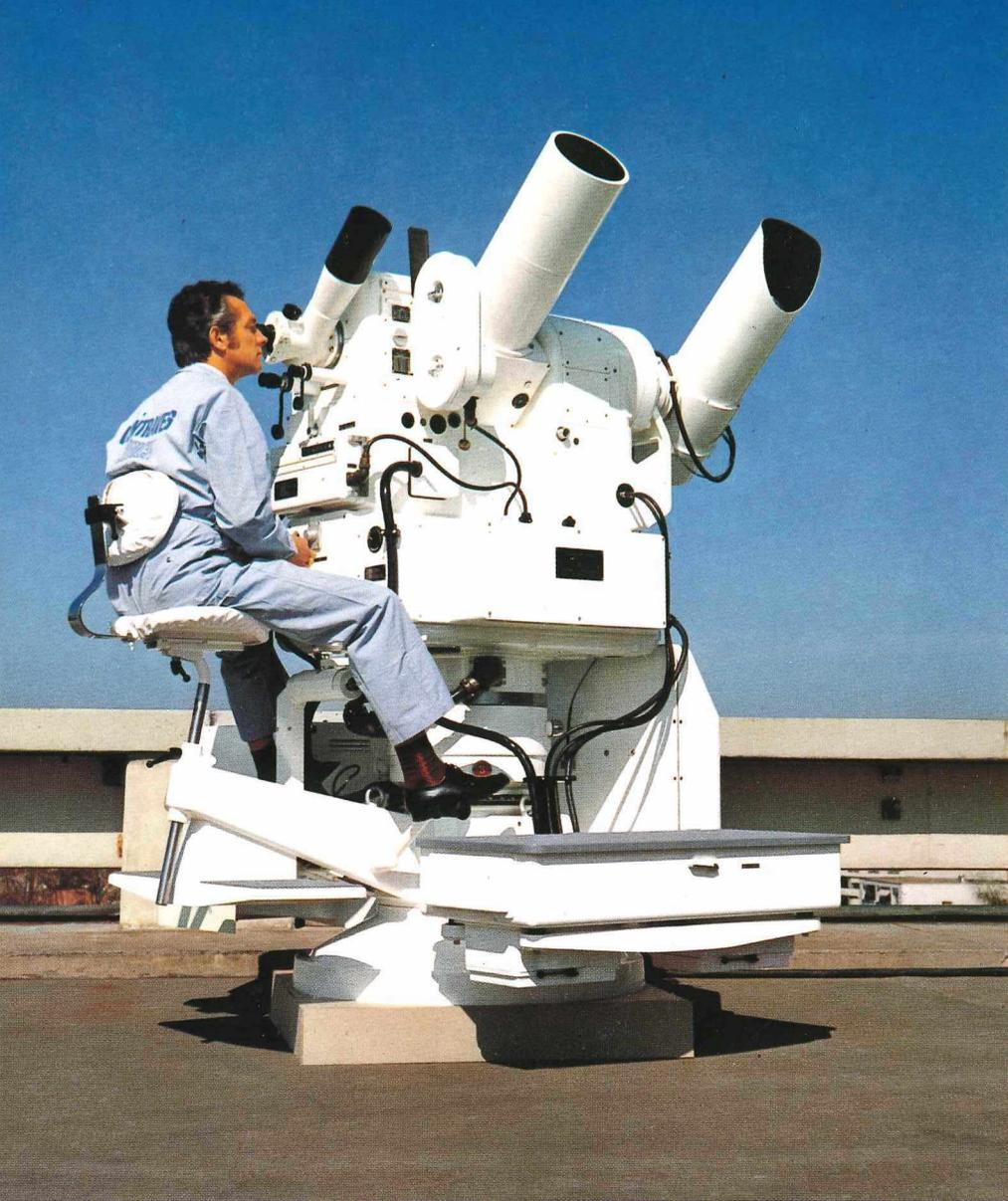
*Kinotheodolit, Modell EOTSF, mit automatischer Infrarot-Nachfolgeausrüstung.*
