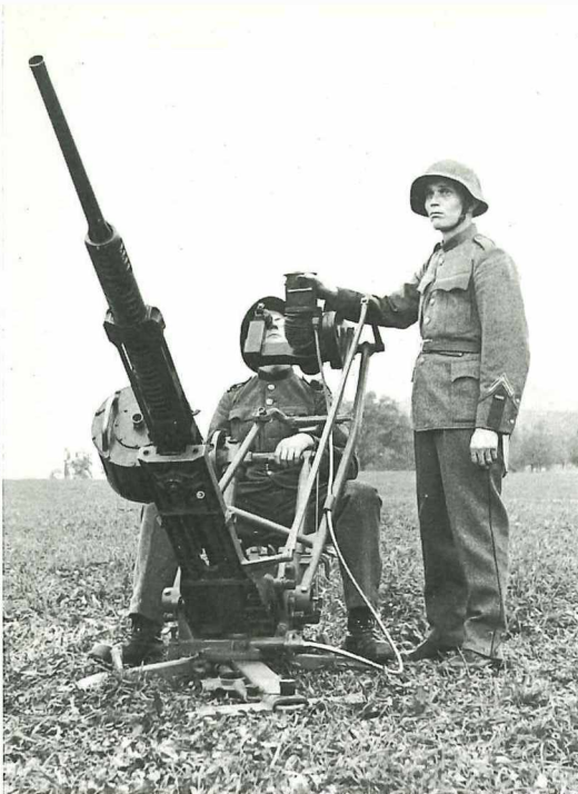
2 Der Kugelkornrechner, das erste Kleinvisier der Contraves, auf einem Oerlikon-20-mm-Geschütz.
