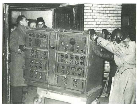
6 Kältetest des ersten Contraves-Feuerleitrechners für die NATO im Kälteraum.
