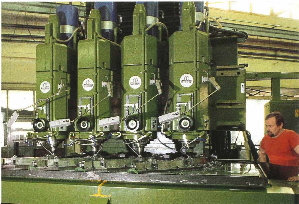
Führungsschienen für Landeklappen des Airbus werden auf Vierspindelfräsmaschinen von Oerlikon Italiana gefertigt.
