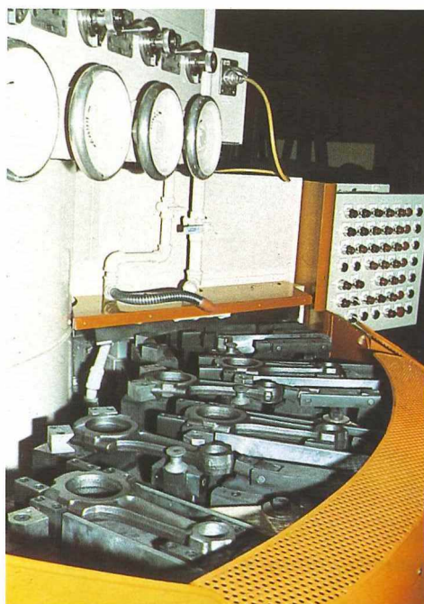
Pleuelstangen bei der Bearbeitung auf einer Blanchard-Schleifmaschine.
