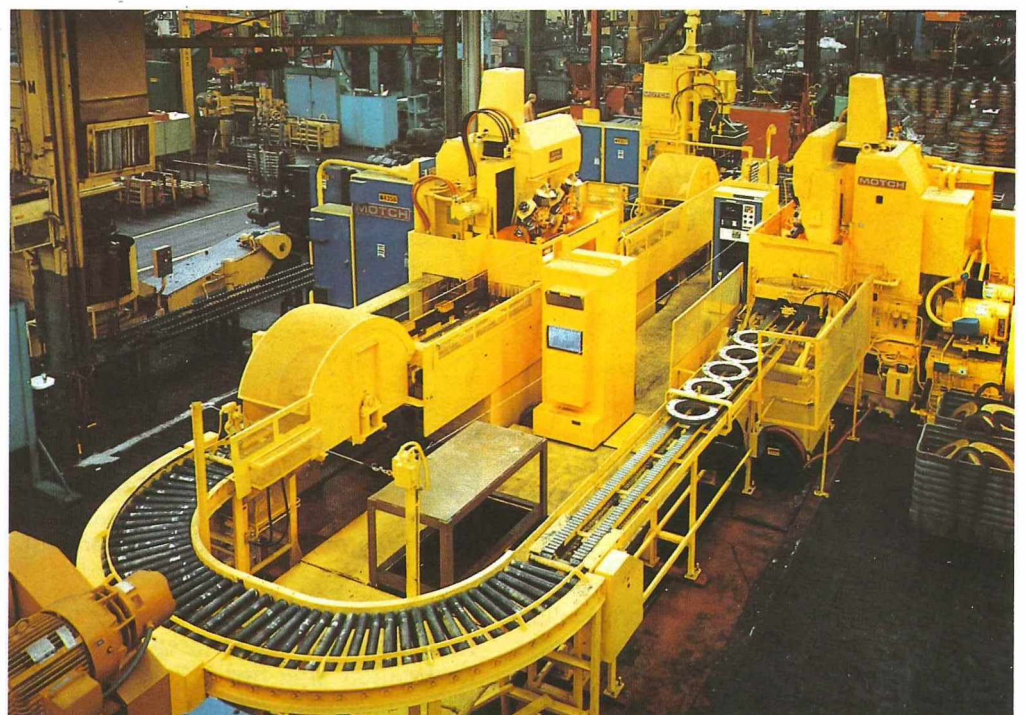
Die von Motch hergestellte flexible Fertigungsanlage für Scheibenbremsen wird computergesteuert und kann von einer einzigen Person bedient werden.
