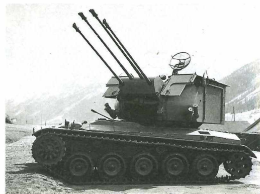
9 20-mm-Vierling-Flakpanzer Oerlikon-Contraves auf dem Flakschiessplatz Zuoz im Engadin (1958).
